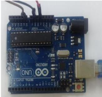
**Figura 5.** Tarjeta microcontroladora Arduino Uno Rev3
