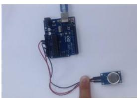
**Figura 3.** Sensor MQ 135 y montaje en placa
