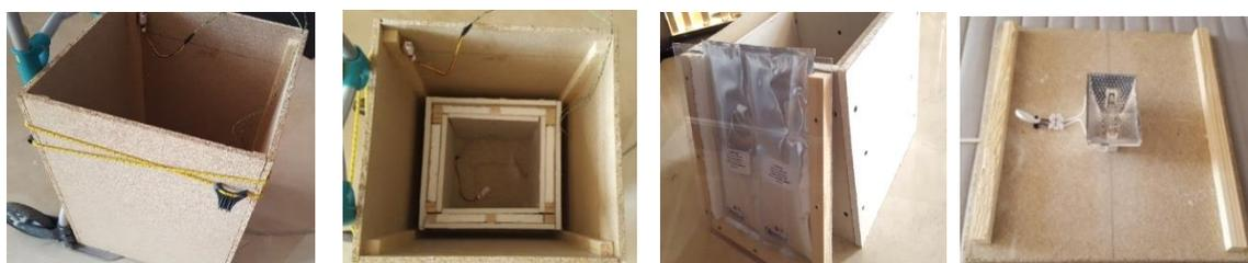
Figura 3. Detalle de construcción de la maqueta, de izq a dcha: cubo exterior, cubo interior aislado con poliestireno, tapa del cubo interior con cámara para alojar PCM, tapa del cubo exterior con lámpara halógena (fuente forzada).
