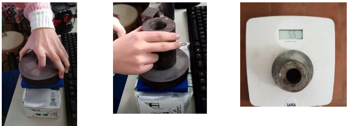
Figura 18: Cálculo de la fuerza de empuje para cilindro C
