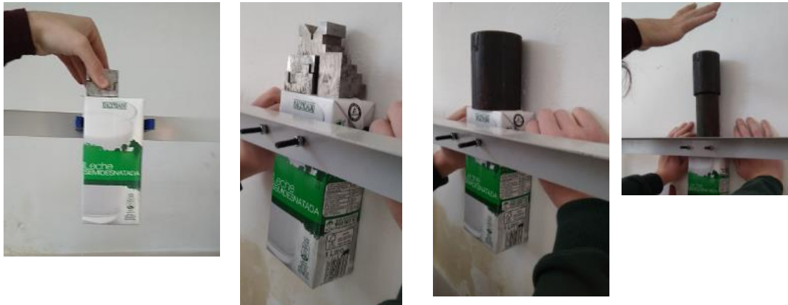
Figura 16: Cálculo de la fuerza de empuje para cilindro B
