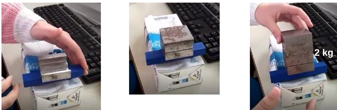
Figura 17: Cálculo de la fuerza de empuje para cilindro A (véase vídeo nº 4)
